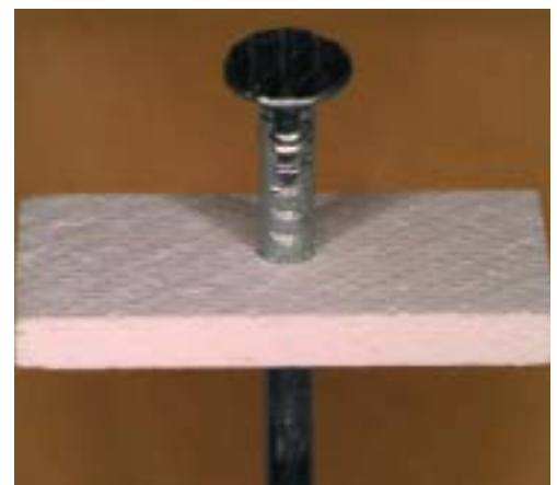
Dr. Reinhard Simon vom MCL entwickelte eine neue Keramik, die sogar genagelt werden kann. Die Eigenschaften der Zähigkeit schaute sich der Werkstoffwissenschaftler von Holz ab.
