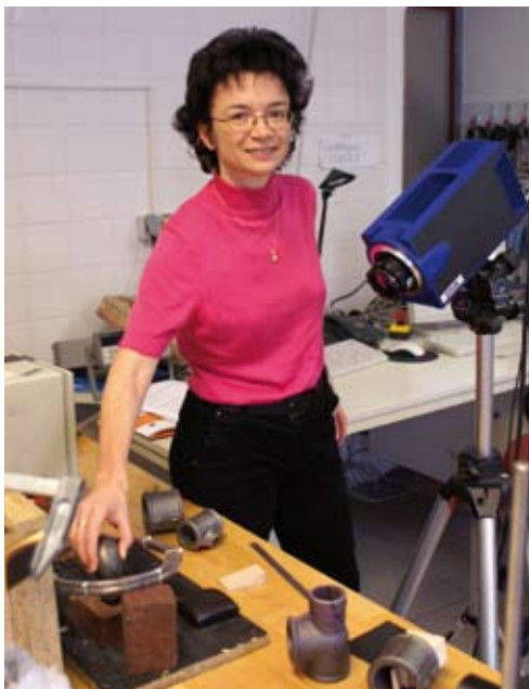
Dr. Beate Oswald-Tranta legt eine Gussprobe in die Induktionsspule, damit mit Hilfe der Infrarotkamera die Schwachstellen ermittelt werden können.
