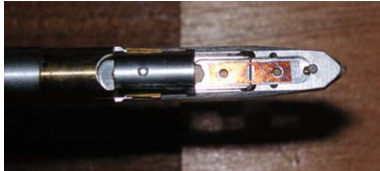
Die winzige Probe wird eingespannt, um im TEM untersucht zu werden.
