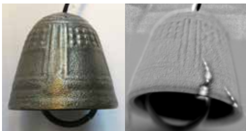
Die kleine gegossene Glocke hat einen Riss, welcher im sichtbaren Bereich nicht erkennbar ist, aber durch die thermografische Prüfung sehr gut sichtbar gemacht wird.
