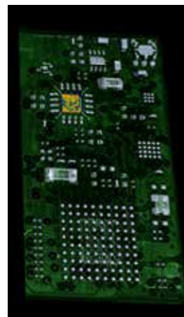
Thermischer Hotspot auf einer Leiterplatte
