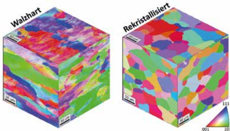
Gefüge von Molybdän im walzharten und rekristallisierten Zustand, aufgenommen mittels Elektronenrückstreubeugung.
