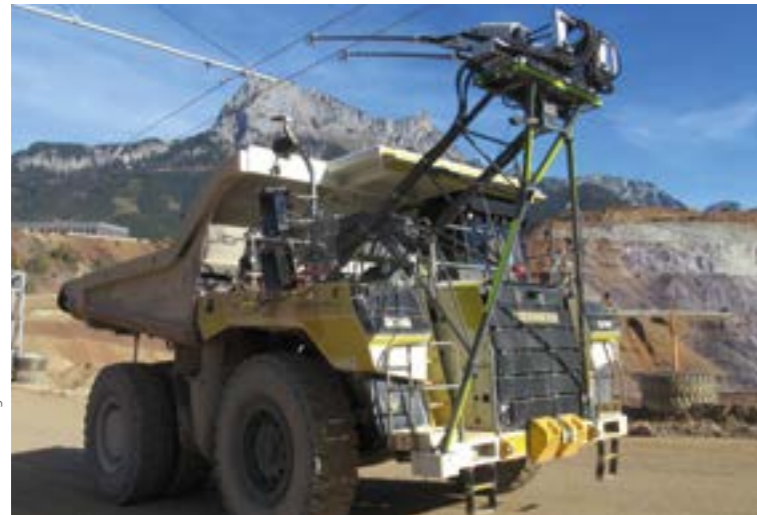
Elektrifizierter Muldenkipper, der bei der VA Erzberg im Einsatz ist.
