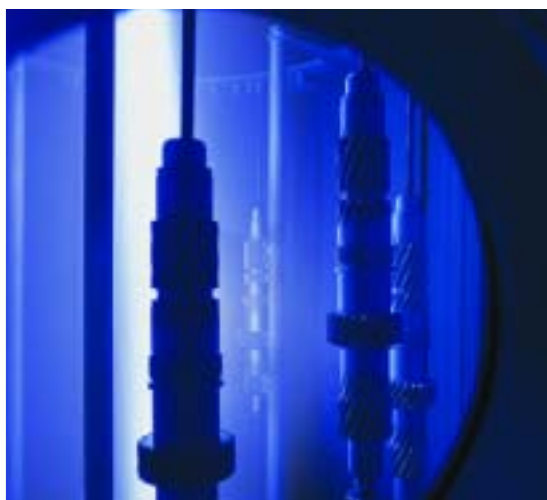
Ziel des neuen CD-Labors „Advanced Hard Coatings“ ist die Entwicklung neuer Beschichtungen für besonders stark beanspruchte Werkzeuge. Dies geschieht mithilfe einer speziellen Beschichtungsmaschine, die der Industriepartner Balzers AG dem Labor zur Verfügung stellt. Foto: Balzers AG
