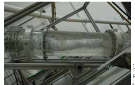
Mithilfe des Zentrifugalkraftscheiders können Altkunststoffe aus gemischten Abfallfraktionen abgetrennt werden.
