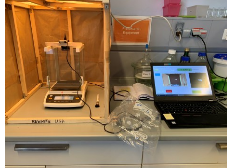
Abbildung 2: Aufbau zur Erfassung des Flächengewichtes.
