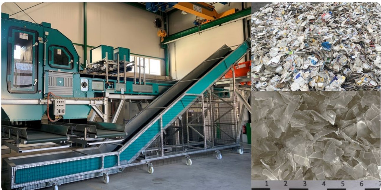
Sensorbasierter Sorter im AVAW-Technikum in St. Michael, sortiertes weiße PP-Leichtverpackungen, gewaschene klare PP-Flakes.
