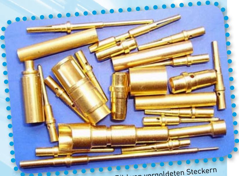
Vergrößertes Bild von vergoldeten Steckern für elektronische Bauteile im Handy
