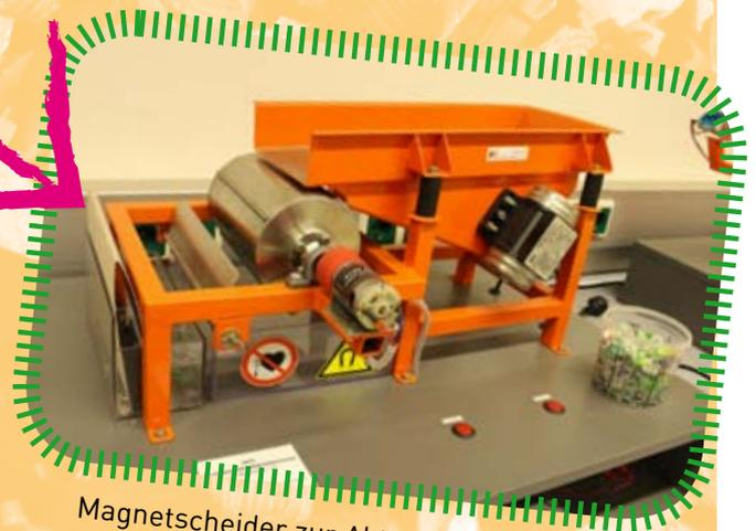
Magnetscheider zur Abtrennung von Eisen
