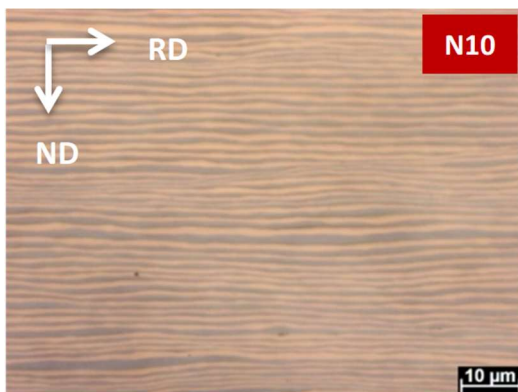
Abbildung: Cu-Nb Laminat nach 10 Walzpässen
