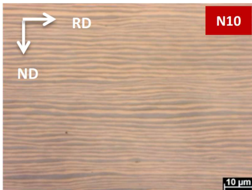
Abbildung: Cu-Nb Laminat nach 10 Walzpässen
