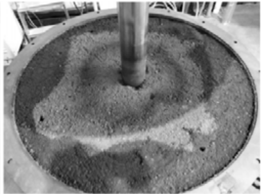
b.) Oberfläche des Bodens nach 9 Stunden und 40 Minuten bei einer mittleren Lanzentemperatur von 1150 K unter Verwendung gezielter Luftführung
