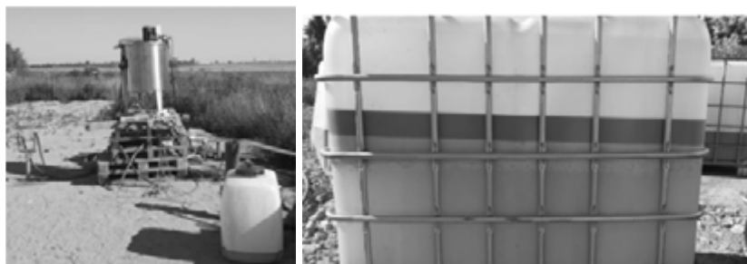
Abb. 2: Die Feldversuche. Links: 300 l Mischer für die Herstellung der Emulsionen aus Pflanzenöl in Wasser. Rechts: Aus dem Boden in Drösing gewonnenes Material, bereits teilweise entmischt. Die Menge der öligen Schicht (schwarz), welche aus einer Mischung aus Pflanzenöl und Mineralöl besteht, beträgt hier etwa 56 Liter, vgl. Tabelle 2
