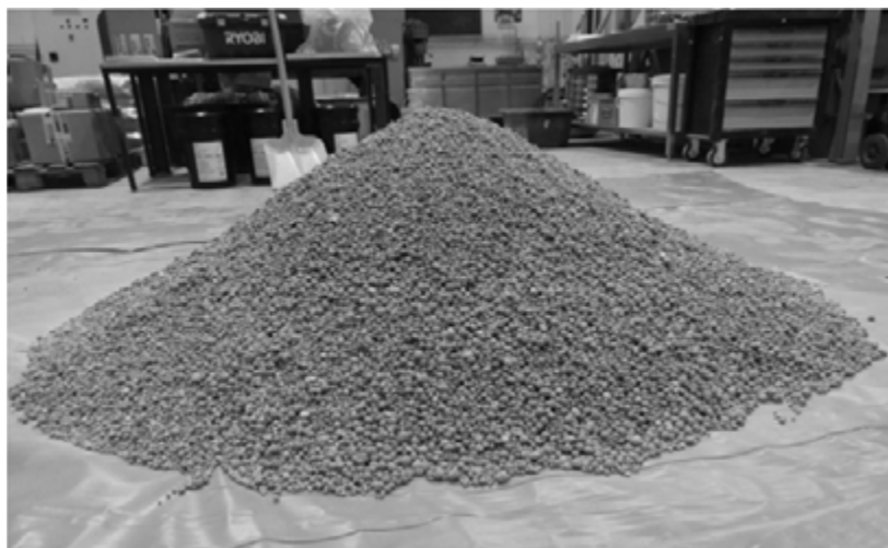
Abb. 4: In der Pilotanlage hergestellte leichte Gesteinskörnungen aus gipshaltigem Mauerwerkbruch für Anwendungsuntersuchungen
