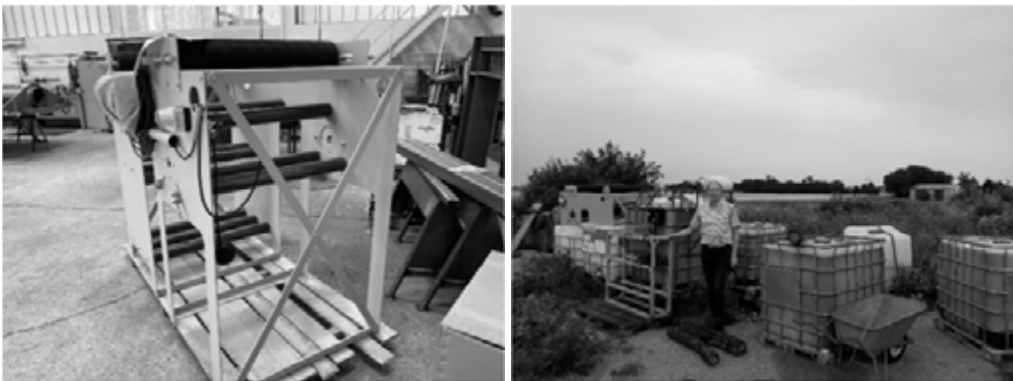
Abb. 2: Links: Aufbau des Schrägbettfilters (SBF) auf Ergebnissen des Scale-up. Rechts: Bei den Feldversuchen. Zu erkennen sind im Vordergrund 2 IBC mit Pflanzenöl/Mineralöl, die mittels Schrägbettfilter abgetrennt werden konnten aus den geförderten 511m 3 Grundwasser. Dieser Versuch zeigte eindrucksvoll die prinzipielle Machbarkeit des Verfahrens. Links hinten der SBF, der in 2 IBC platziert wurde. Rechts neben dem Autor befindet sich einer der Labor-Prototypen
