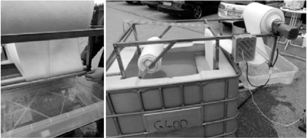
Abb. 1: Versuche zur Ölabtrennung mit Vliesen mit 1m 3 Prototyp auf Basis eines IBC. Restölgehalt im Wasser 0,5 bis 1,5mg/l, Wassergehalt im Öl max. 2%
