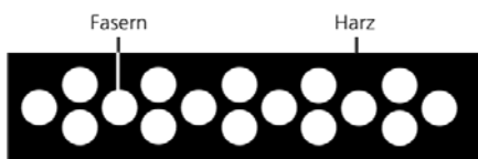
Abb. 1: Schematischer Aufbau von Faserverbundkunststoffen.
