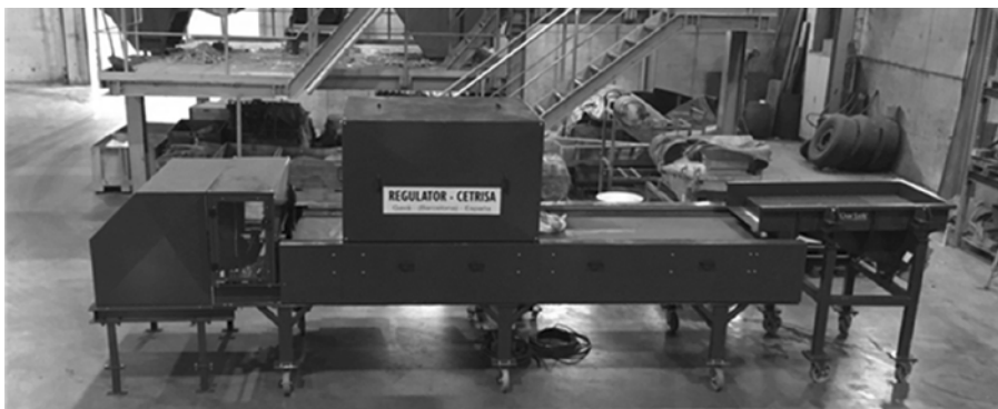
Abb. 2: Prototyp der SHREDDERSORT LIBS-Sortieranlage.
