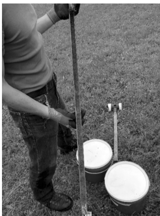
Abb. 3: In-situ-Probenahme mittels eines Pürckhauer-Bohrstockes mit der Möglichkeit, den Boden in zwei unterschiedlichen Tiefen zu untersuchen.
