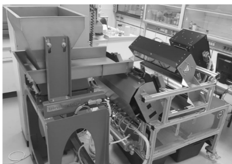
Abb. 1: Versuchsstand für sensorgestützte Erkennung und Sortierung am AVAW (links); Schematische Darstellung des Funktionsprinzips und Sensoranordnung des Sortierers (rechts).
