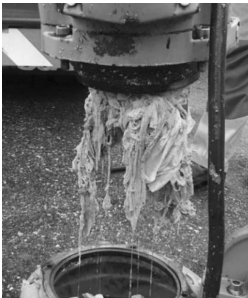
Abb. 6: Zerlegte Pumpe mit Verzopfung aus FT aus einer Pumpstation in Kapfenberg.
