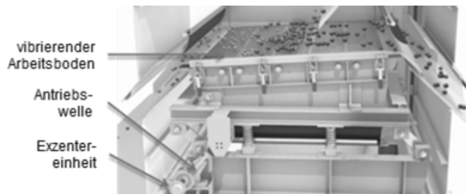
Abb. 4: Blick in das Innere des GSort im Betrieb.
