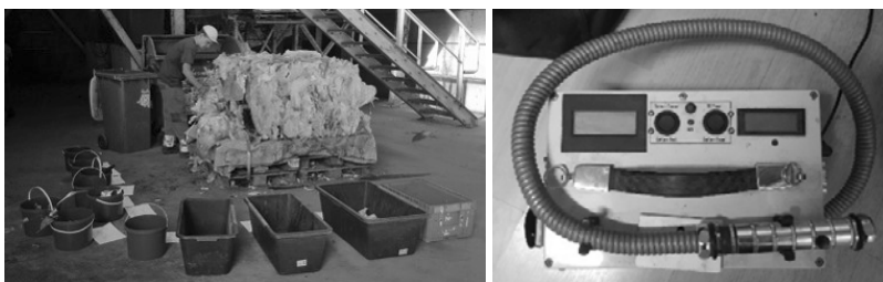
Abb. 4: Manuelle Ballensortierung (li.); Portables NIR-Spektrometer zur Kunststofferkennung (r.).
