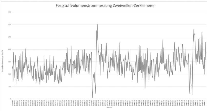
Abb. 5: Förderverhalten eines Zweiwellen-Kammwalzen-Zerkleinerers.
