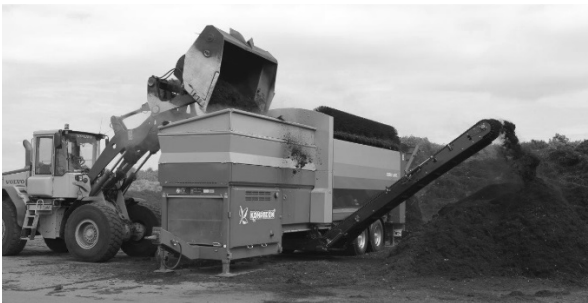
Abb. 2: Abschließendes Sieben bei der Aufbereitung von Bodenaushub zur Komposterde.
