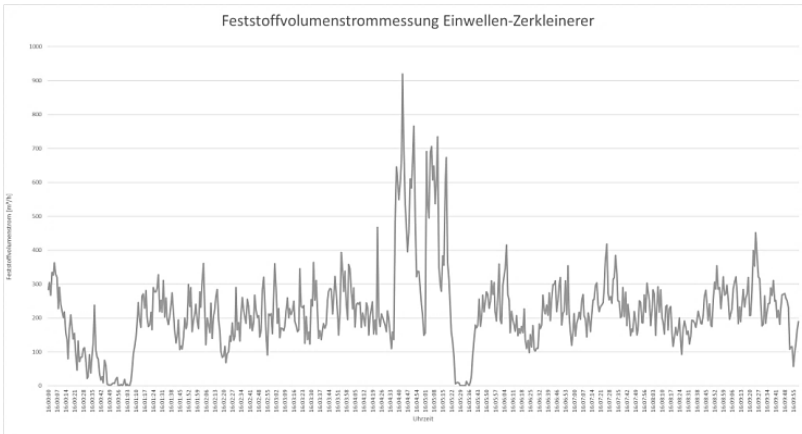
Abb. 4: Förderverhalten eines Einwellen-Kammwalzen-Zerkleinerers.
