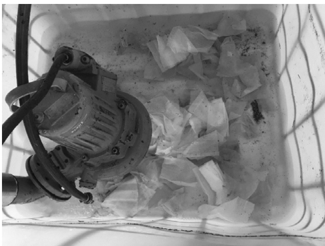
Abb. 3: Versuchsanlage zur Pumpenverstopfung durch FT.
