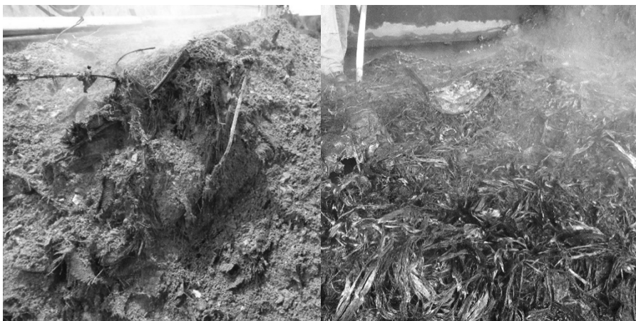
Abb. 3: Aufnahmen der Schlacken bei Einsatz von Carbonfaser-haltigen Abfällen in der Müllverbrennungsanlage (links) und Sonderabfallverbrennungsanlage (rechts).
