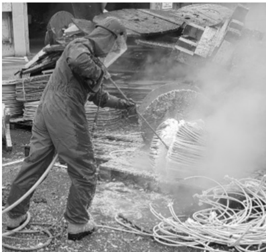
Abb. 3: Versuch Wasserstrahlschneiden für Entwicklung Seil/Netzvorbehandlungsanlage.
