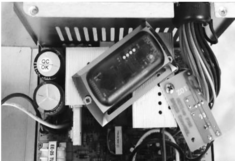
Abb. 2: Befestigung der Datenlogger.
