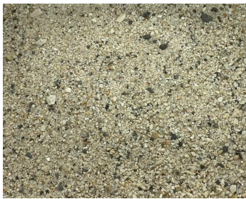
Abb. 1 und 2: Quarzsand aus Namibia. Eingangsprobe. Optischer Eindruck (links) und Korngrößenverteilung (rechts)
