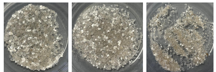
Abb. 7 – 9: Quarzsand aus Namibia. Glimmerkonzentrate nach Elektroscheidung. Korngrößenklassen 2/1 mm, 1/0,71 mm, 0,71/0,5 mm (v.r.n.l.)
