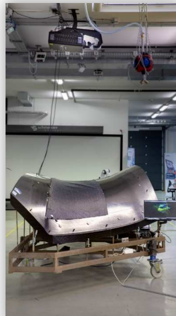
Winglet Werkzeug FACC industrielle Baustellenmontage
